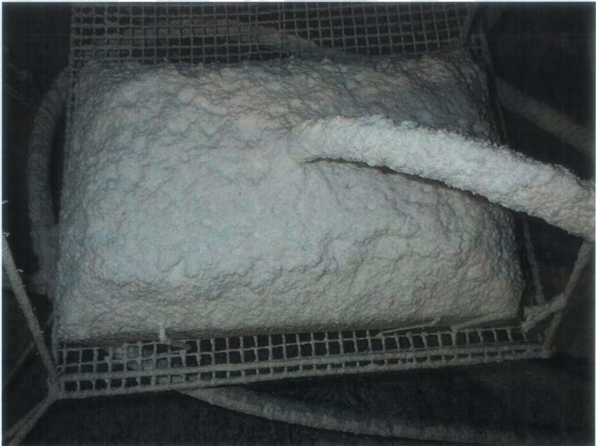
じんあい試験後の状況
